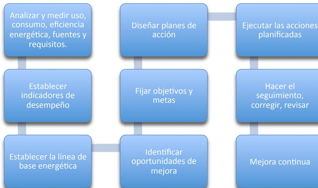
Figura 28. Proceso de diseño, implantación y mantenimiento de un SGE
